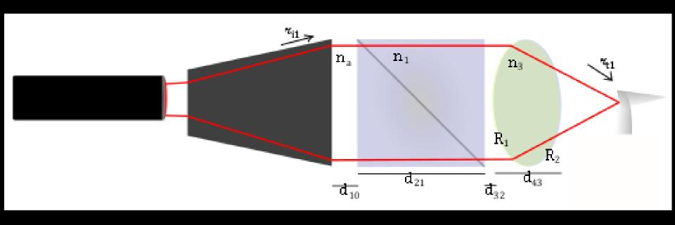
$$A = \begin{bmatrix} 1 & -\left(\frac{n_a - n_3}{R_2}\right) \end{bmatrix} \begin{bmatrix} 1 & 0 \\ \frac{d_{43}}{n_3} & 1 \end{bmatrix} \begin{bmatrix} 1 & -\left(\frac{n_3 - n_a}{R_1}\right) \end{bmatrix} \begin{bmatrix} 1 & 0 \\ \frac{d_{32}}{n_a} & 1 \end{bmatrix} \begin{bmatrix} 1 & 0 \\ \frac{d_{21}}{n_1} & 1 \end{bmatrix} \begin{bmatrix} 1 & 0 \\ \frac{d_{10}}{n_a} & 1 \end{bmatrix}$$
